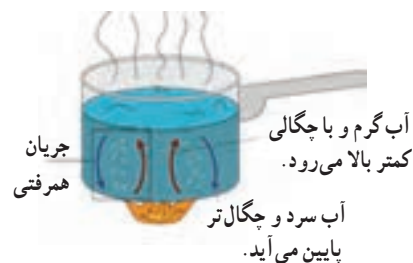
شکل ۴-۳۳ گرم شدن آب درون قابلمه به روش همرفت
