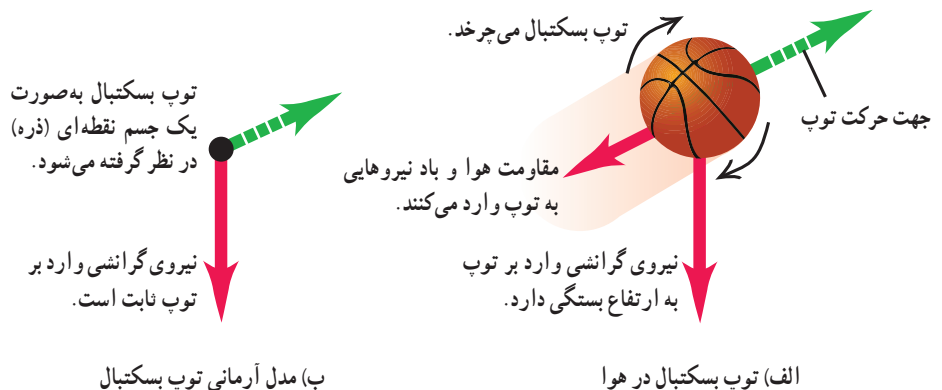
شکل ۳-۱ استفاده از یک مدل آرمانی برای ساده‌سازی تحلیل حرکت یک توپ بسکتبال در هوا
